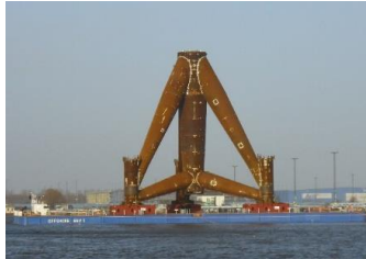
Tripod-Sockel für offshore WKA Quelle: Bittner Group
